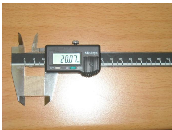
Εικ. 2: Σύγχρονο ηλεκτρονικό παχύμετρο Mitutoyo που έγιναν οι μετρήσεις διαστάσεων
